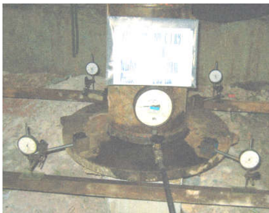
Hình 2. Minh họa thiết bị đo lực và đồng hồ chuyển vị thí nghiệm nén tĩnh cọc (Nguồn: https://hoplong1295.com/thu-nghiem-kiem-tra-suc-chiu-tai-cua-coc/ )
