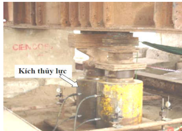
Hình 2. Minh họa thiết bị đo lực và đồng hồ chuyển vị thí nghiệm nén tĩnh cọc (Nguồn: https://hoplong1295.com/thu-nghiem-kiem-tra-suc-chiu-tai-cua-coc/ )
